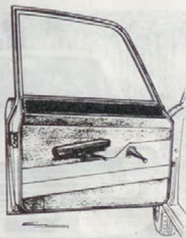
Interior de la puerta delantera. Bajo el apoyacodos está la palanca de apertura. Falta el bolsillo portamapas.
